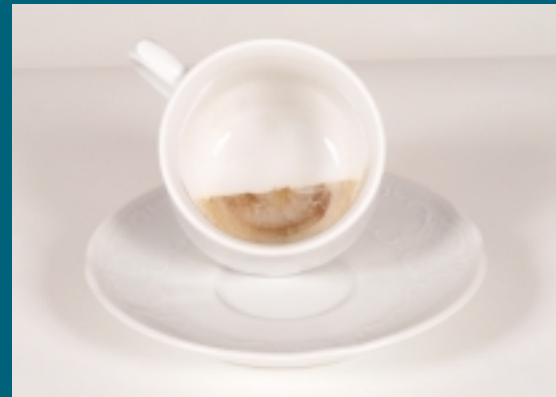
AUF DER NANOPOL® BESCHICHTETEN TASSENHÄLFTE BLEIBEN KEINE RÜCKSTÄNDE HAFTEN, SELBST LIPPENSTIFT HÄLT NICHT MEHR. LANGES EINWEICHEN UND SCHEUERN ENTFÄLLT
