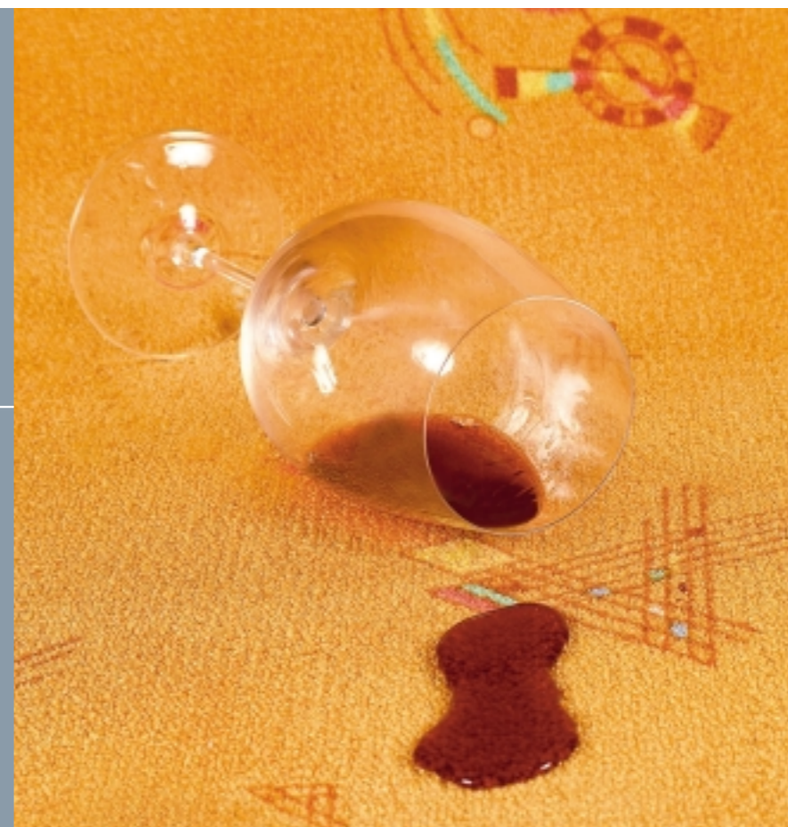
AUF DEM NANOPOL® BESCHICHTETEN TEPPICH KANN DER ROTWEIN NICHT MEHR IN DIE FASERN EINDRINGEN. AUF UNBESCHICHTETEN TEPPICHEN DABEGEN KÖNNEN FLECK-ERZEUGENDE FLÜSSIGKEITEN SOFORT EINZIEHEN.
