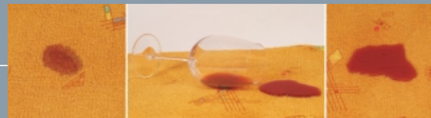
AUF DEM NANOPOL® BESCHICHTETEN TEPPICH KANN DER ROTWEIN NICHT MEHR IN DIE FASERN EINDRINGEN. AUF UNBESCHICHTETEN TEPPICHEN DABEGEN KÖNNEN FLECK-ERZEUGENDE FLÜSSIGKEITEN SOFORT EINZIEHEN.
